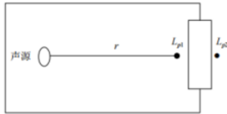
图 4-2 室内声源等效为室外声源图例
