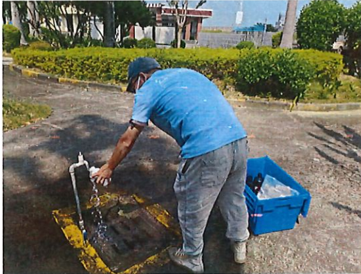
第二水厂出厂水采样口
